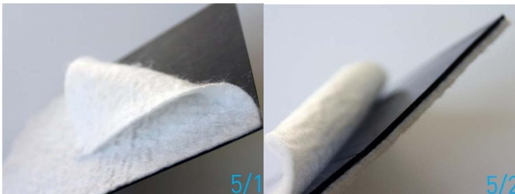
Рис. 2 – Геомембрана - тонкий, однородный по всей площади полимерный лист, обладающий стопроцентной непроницаемостью, который предназначен для обеспечения гидроизоляции и создания геологических барьеров для защиты почвы и грунтовых вод от загрязнения токсичными веществами.
