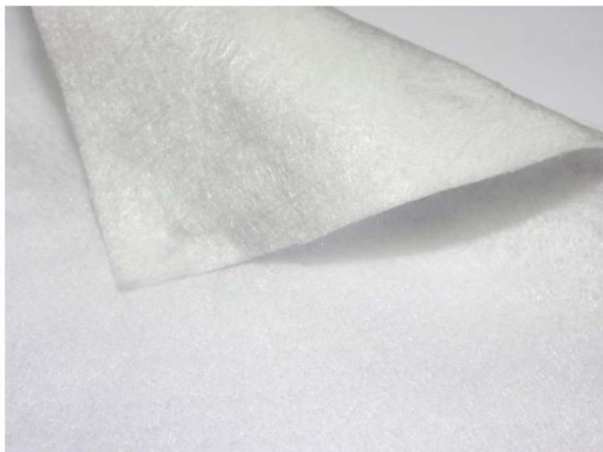
Рис. 1 – Геотекстиль - высокопрочное нетканое полотно из полимерных волокон
